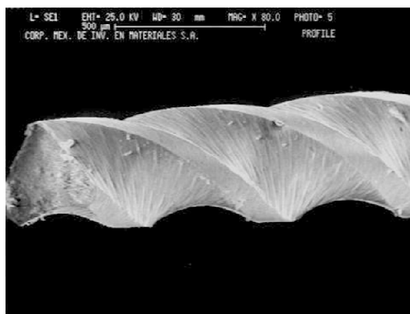
Figura 1. Imagen de MEB de un instrumento Profile .04 fracturado. Las hojas de corte actúan como concentradores de esfuerzos donde la fractura podría iniciarse (Magnificación original 80X)
